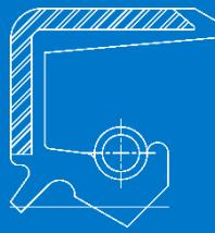
El perfil TZ es un retén radial para sellado de eje compuesto de una sola jaula metálica externa con un revestimiento interno y al final de goma, un labio primario de estanqueidad con muelle integrado y un labio anticontaminación adicional.
