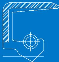
El perfil SM es un retén radial para sellado de eje compuesto de una sola jaula metálica externa con un revestimiento interno de goma y un labio primario de estanqueidad con muelle integrado.
